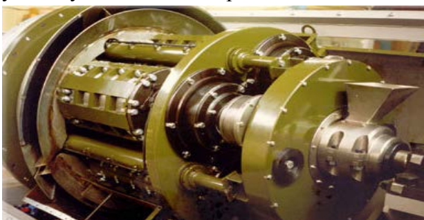
Рис. 6. Промышленная планетарная мельница конструкции «ТТД – Балтиец»
