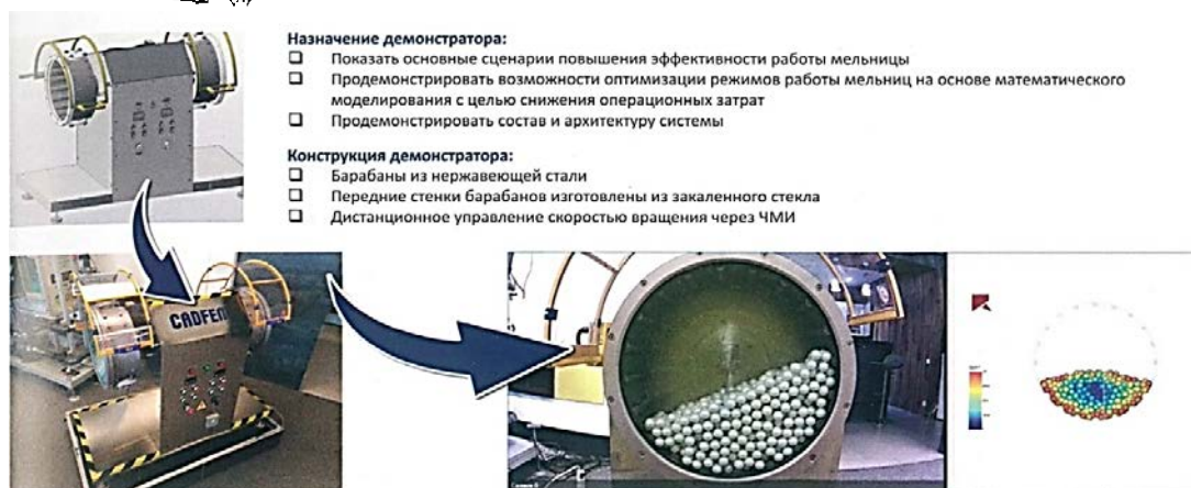
Рисунок 3 - Демонстратор цифрового двойника барабанной мельницы (АО «Моделирование и Цифровые Двойники», Россия)
