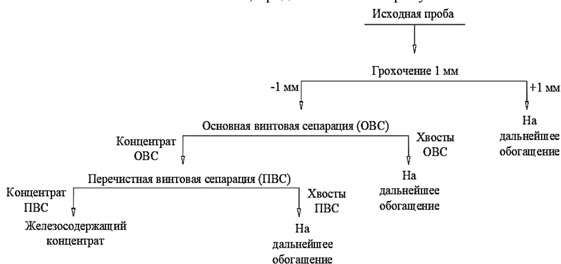
Рисунок 1 – Схема тестовых испытаний на сливе классификатора
