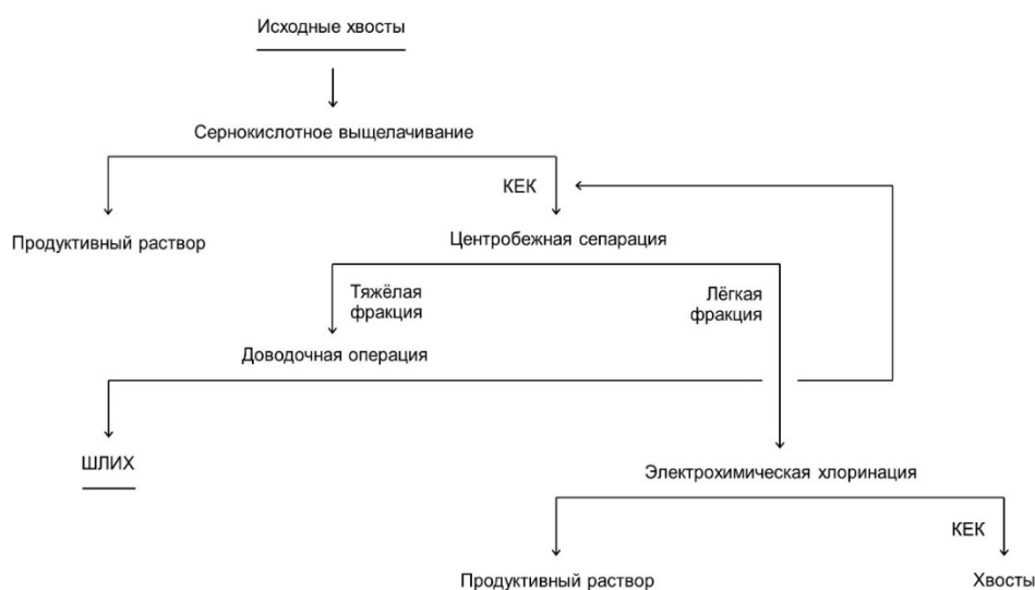
Рисунок 1 - Схема комплексной технологии переработки хвостов флотационного обогащения
