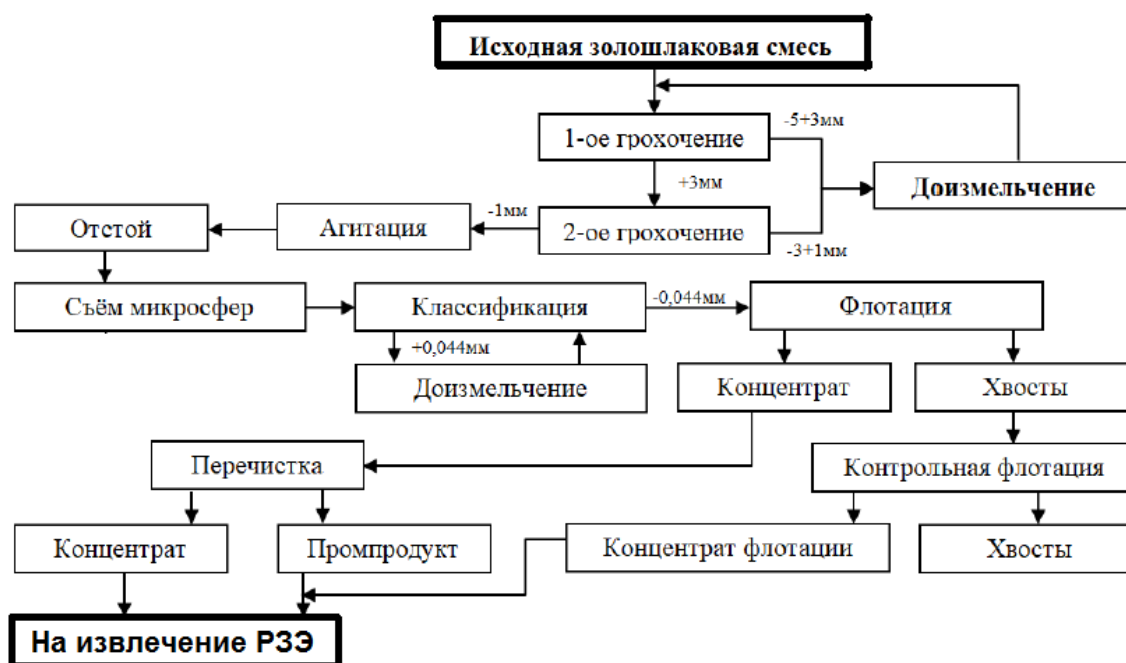
Рисунок 1 - Принципиальная схема комплексной переработки золошлаковых отходов с извлечением микросфер и концентрата редкоземельных элементов
